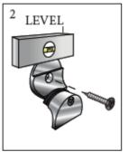
I - DISASSEMBLE THE WALLBRACKET AND ATTACH THE BACK HALF OF THE BRACKET AND GASKET TO THE WALL.
